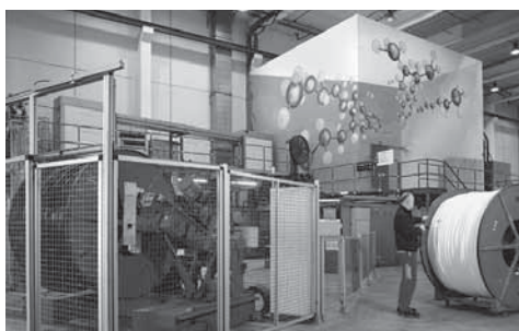
Rysunek 32 Bunkier w którym odbywa się proces sieciowania
