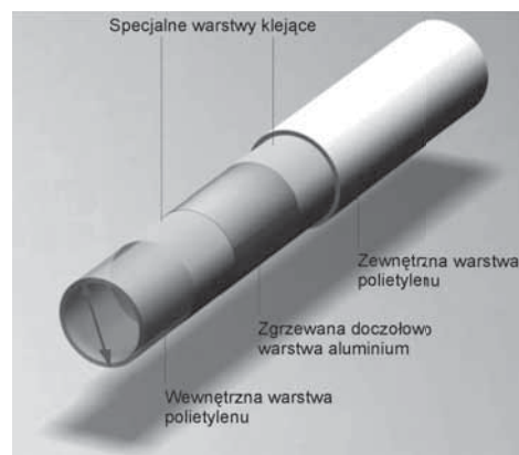
Rysunek 38 Budowa rury Purmo HKS
