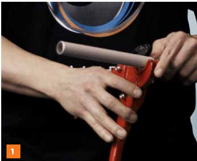
Prawidłowe ucięcie rury za pomocą nożyc
